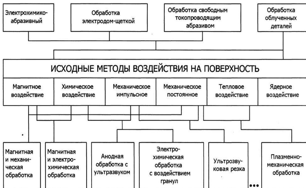
*Рисунок 1 - Воздействия при КМО*
