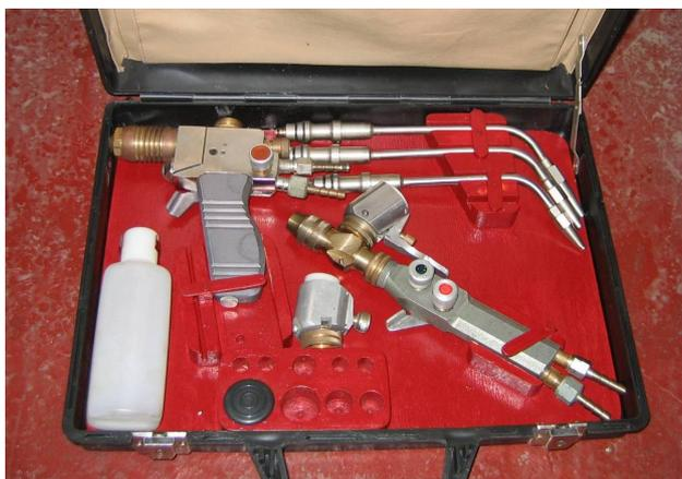
Рисунок 1 – Комплект дозующих горелок для газопламенного напыления и газопорошковой наплавки фирмы «ТЕРМИКА»
