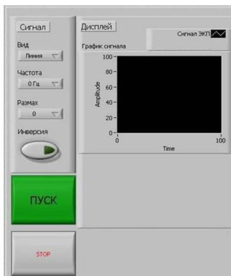
Рисунок 2 – Лицевая (интерфейсная) панель ГТС-В
