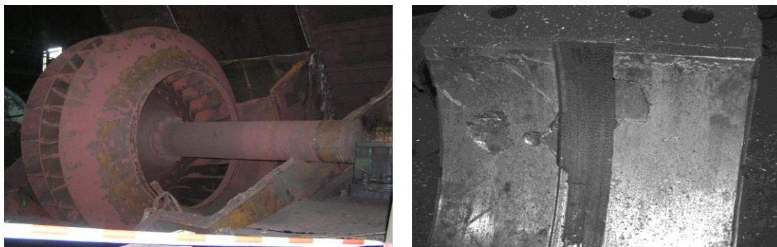
Рисунок 2 – Коксование лопаток ротора, приведшее к выкрашиванию вкладыша подшипника
