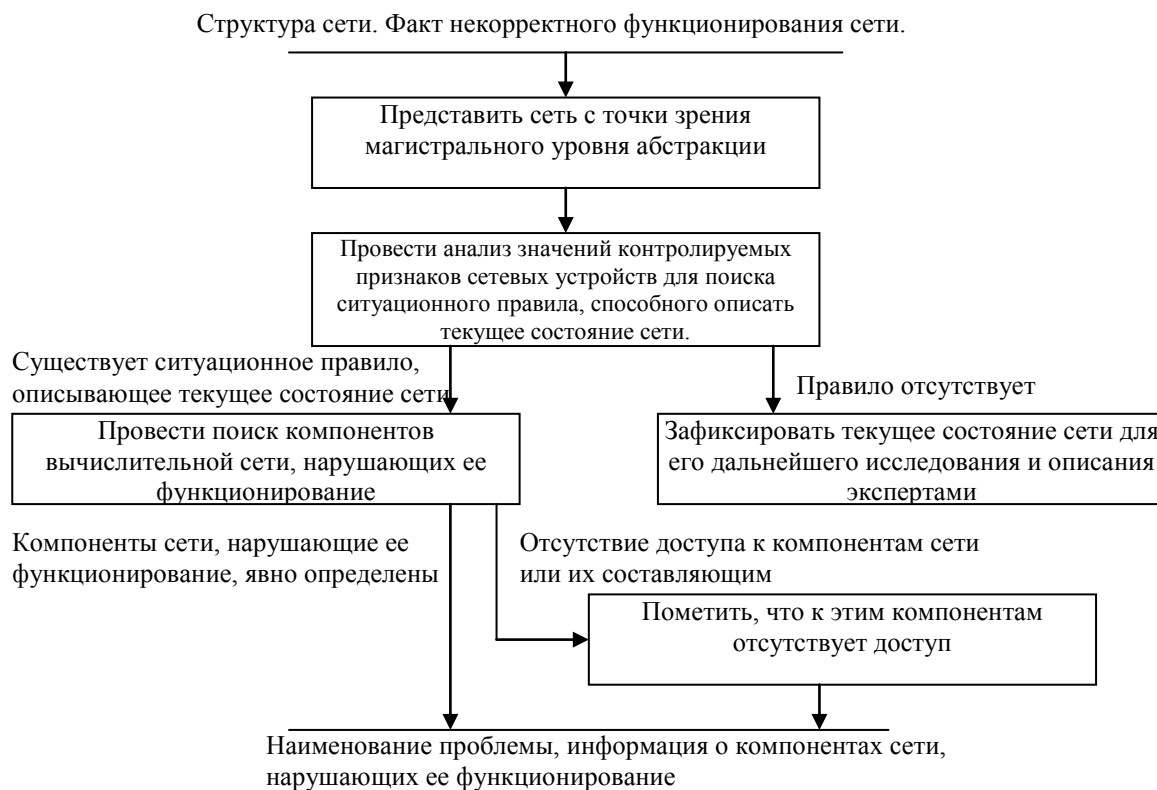
Рисунок 1 - Методика локализации проблемы функционирования вычислительной сети
