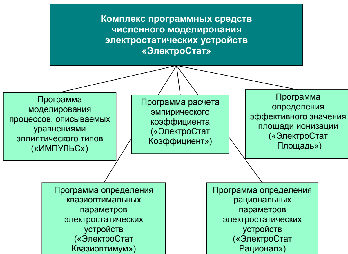
Рисунок 1 – Структура комплекса программных средств численного моделирования электростатических систем «ЭлектроСтат»
