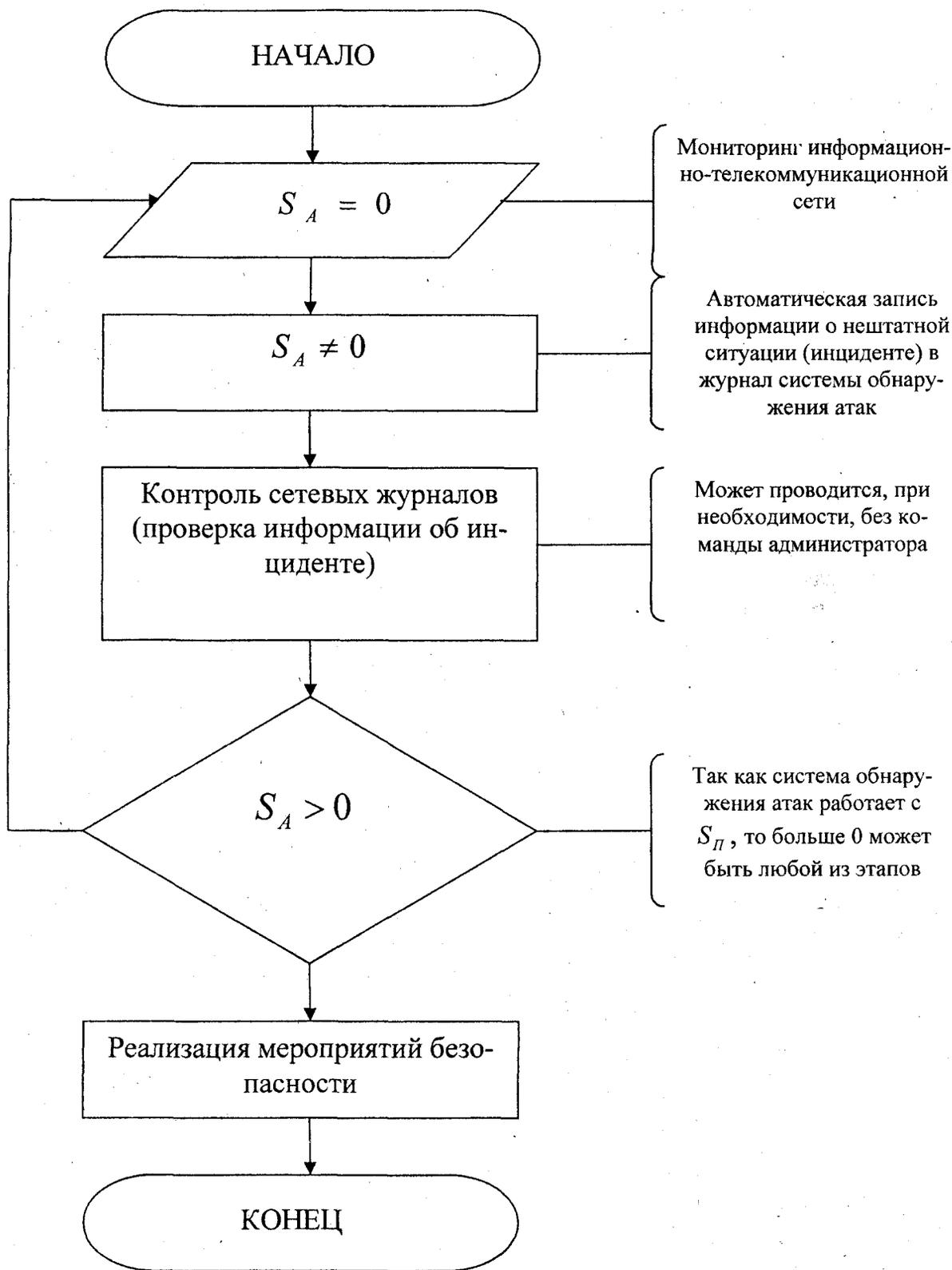
Рисунок 1 – Примерная блок-схема алгоритма реагирования системы обнаружения атак на нештатные ситуации
