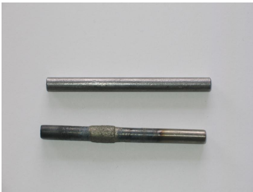
РИС. 1 - ОБРАЗЕЦ ДЛЯ ОПРЕДЕЛЕНИЯ ПРОЧНОСТИ СЦЕПЛЕНИЯ НА СДВИГ.
