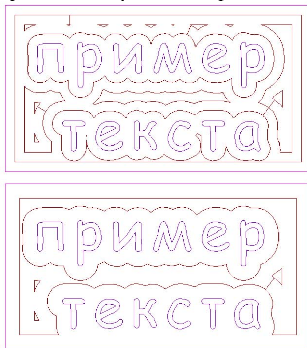
Рисунок 3. Траектория движения фрез диаметром 2 мм и 3 мм.
