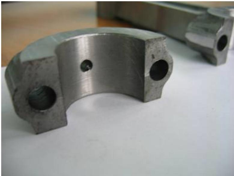
Рис. 6 – Нижняя головка шатуна до нанесения алюминиевого слоя.
