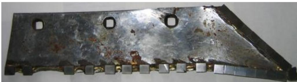
Рис. 10. Лемех после эксплуатационных испытаний
