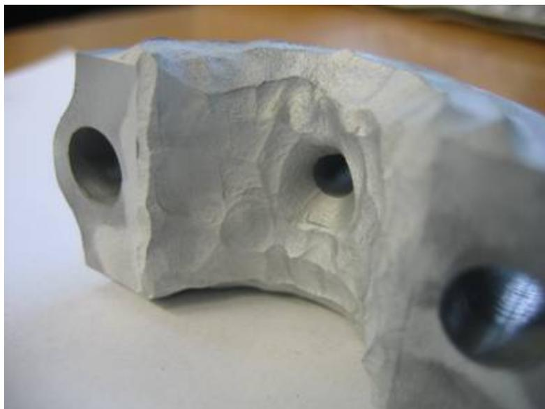
Рис. 7 – Нижняя головка шатуна после нанесения алюминиевого слоя.
