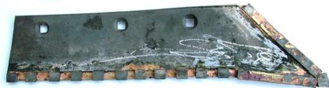
Рис. 9. Лемех с лицевой стороны напаянный металлокерамическими пластинами с использованием водородно-кислородного пламени
