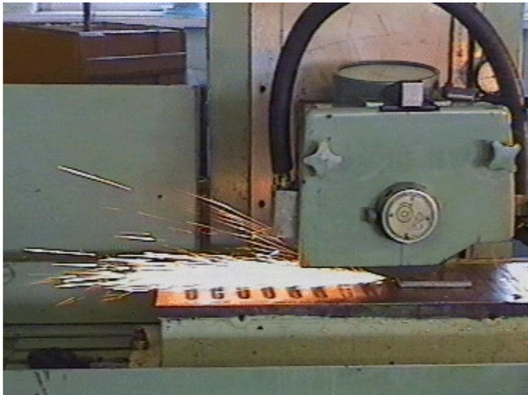
Рисунок 2 – Направленный поток шлама (факел), образующийся при плоском шлифовании продольно-прерывистым шлифовальным кругом
