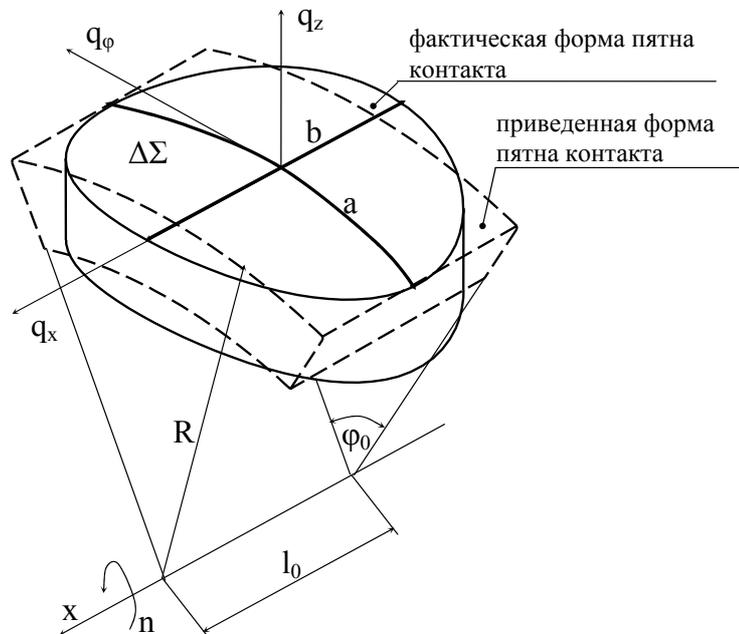
Рисунок 2 - Элемент цилиндра в зоне поверхностного контакта
