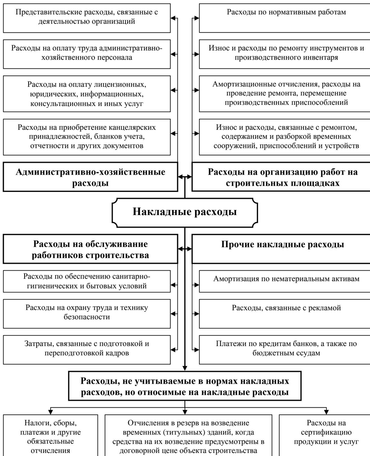
*Рисунок 5 – Классификация накладных расходов, учитываемых при формировании сметной стоимости строительно-монтажных работ*
