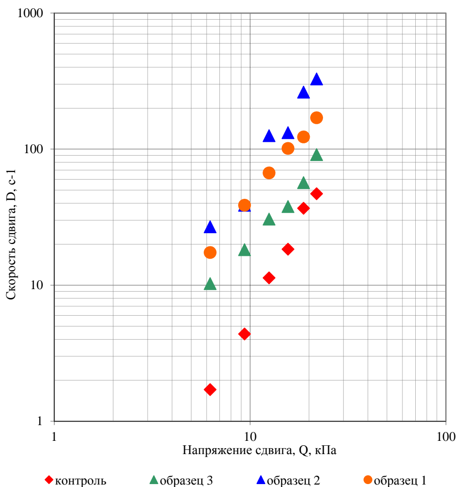
Рисунок 1 – Кривые течения \lg \theta = \lg \theta(\lg D) для исследуемых образцов теста в логарифмических координатах
