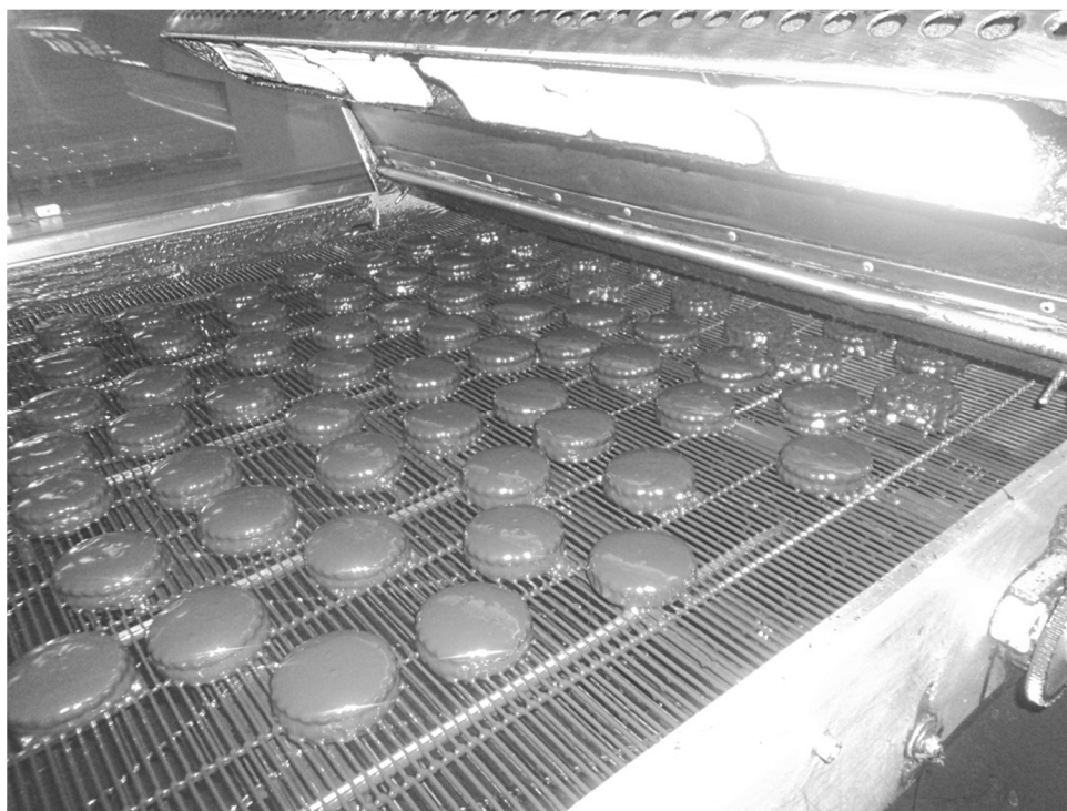
Рисунок 5 – Система циркуляции воздуха и обдува поверхности изделия
