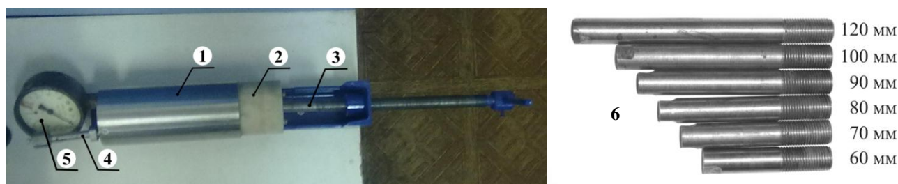
Рисунок 1 – Установка для проведения капиллярной вискозиметрии
