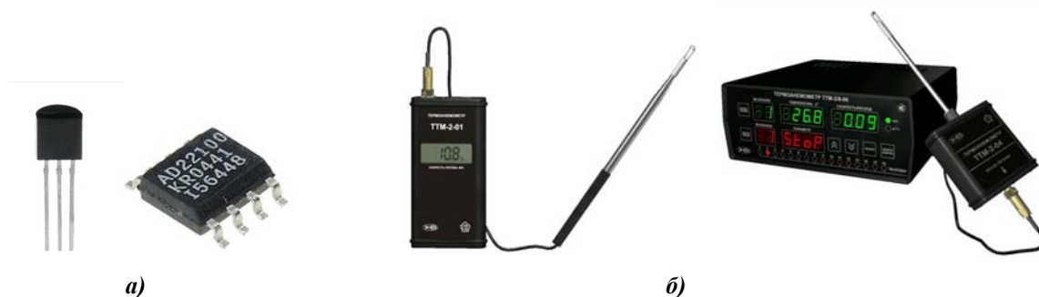
Рисунок 3 – Измерительные приборы и первичные преобразователи температуры и скорости движения воздуха
