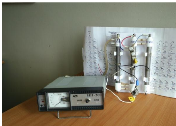
Рисунок 4 – Лабораторная установка для исследования процесса электрохимического воздействия на молоко
