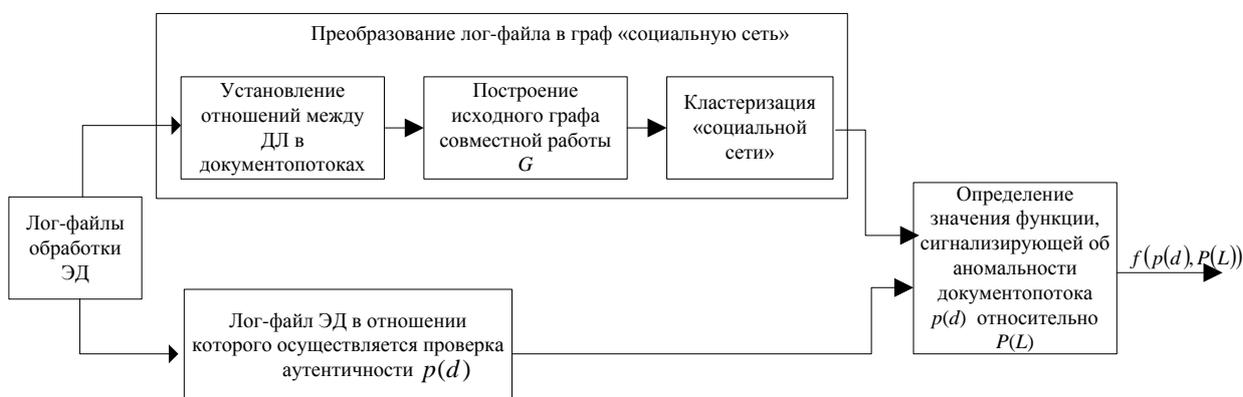
Рисунок 2 – Обобщенная схема выявления угрозы нарушение состава ДЛ, участвующих в процессе обработки ЭД в СЭД с использованием аппарата анализа «социальных сетей»
