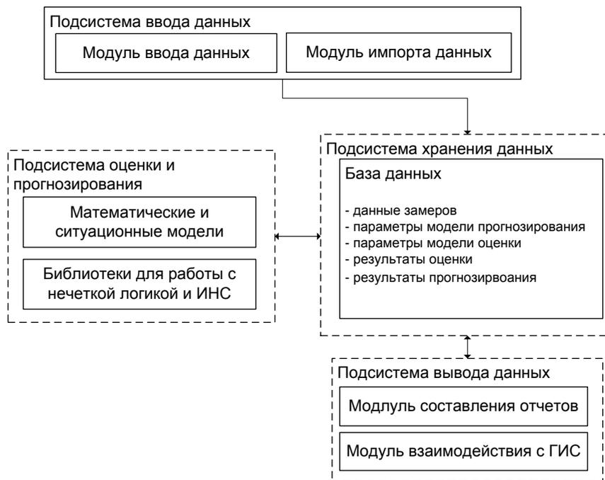
**Рисунок 2 – Структурная схема системы автоматизированного мониторинга сельско-городских территорий**
