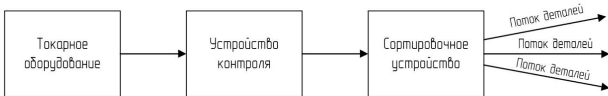
Рисунок 2 – Схема сортировки изделий
