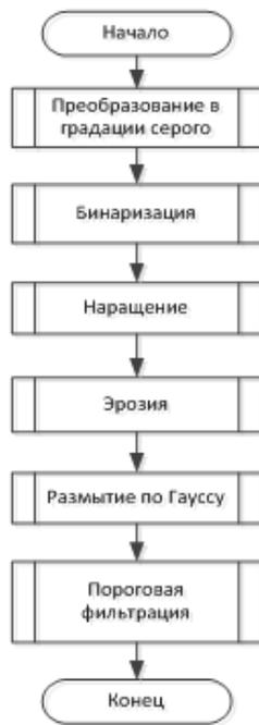
Рисунок 2 – Предварительная обработка изображения ИМС
