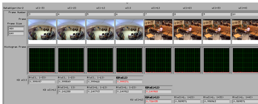
Рисунок 5 – Принцип работы методики, основанной на корреляционном анализе Red-гистограмм при двух и трех кадрах вставок
