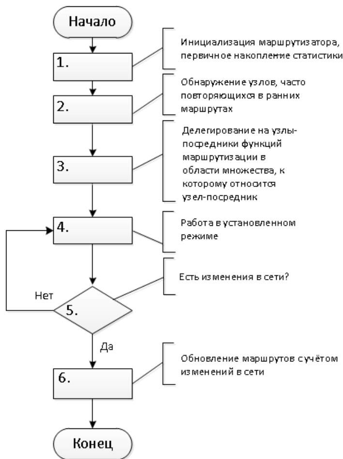
Рисунок 2 – Схема работы алгоритма самоорганизации сети
