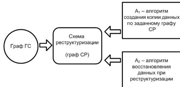
Рисунок 5 – Наглядное представление графоаналитической модели процесса формирования глобальной схемы мультибазы данных с учетом этапов ее реструктуризации
