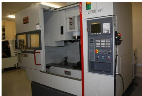
Рисунок 1 – Фрезерный обрабатывающий центр Quaser MV154
