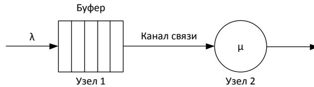
Рисунок 2 – Схема передачи кадров между узлами 1 и 2
