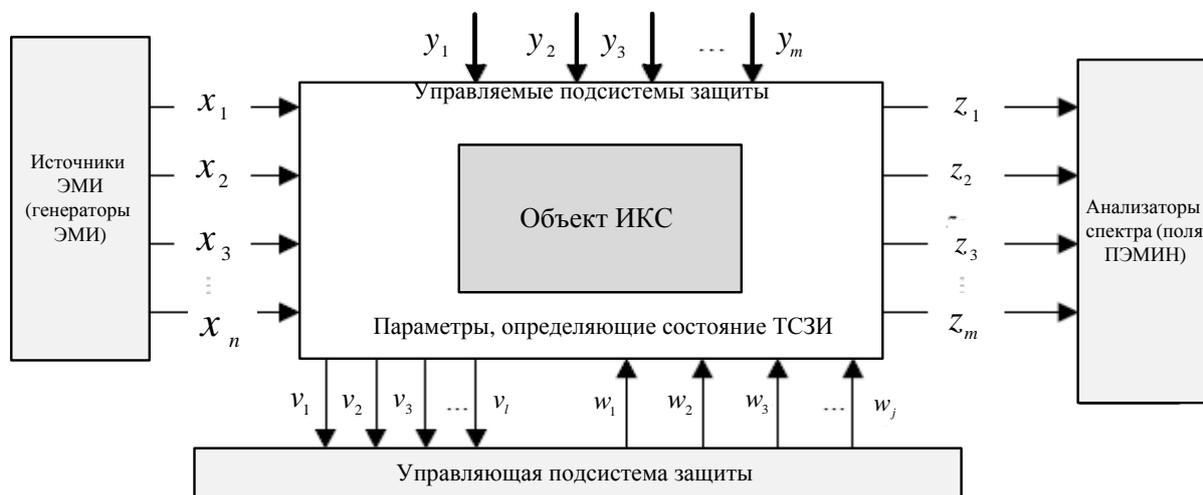
*Рисунок 2 – Формализованная структура мониторинга электромагнитной обстановки, подавления поля ЭМИ и локализации (устранения) опасных каналов утечки информации*
