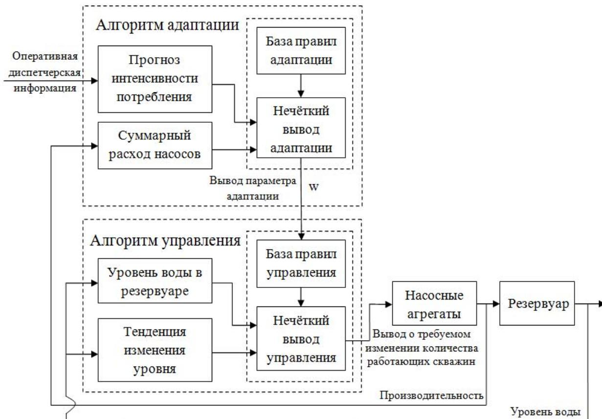
Рисунок 2 – Схема нечеткого адаптивного управления
