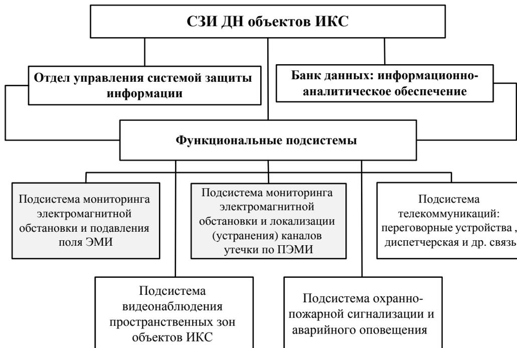
Рисунок 1 – Вариант структуры СЗИ ДН объектов ИКС
