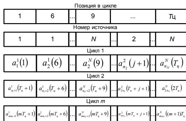
**Рисунок 2 – Структурная модель мультиплексного цифрового потока**
