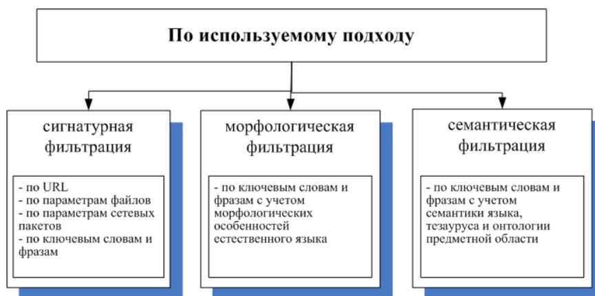
**Рисунок 6 – Классификация методов фильтрации по используемому подходу**
