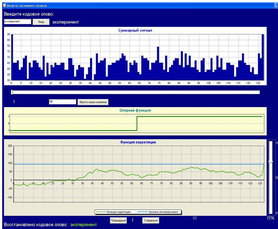
**Рисунок 5 – Макет ортогональной системы с восстановленным принятым сообщением при уровне интегрирования 0,72**
