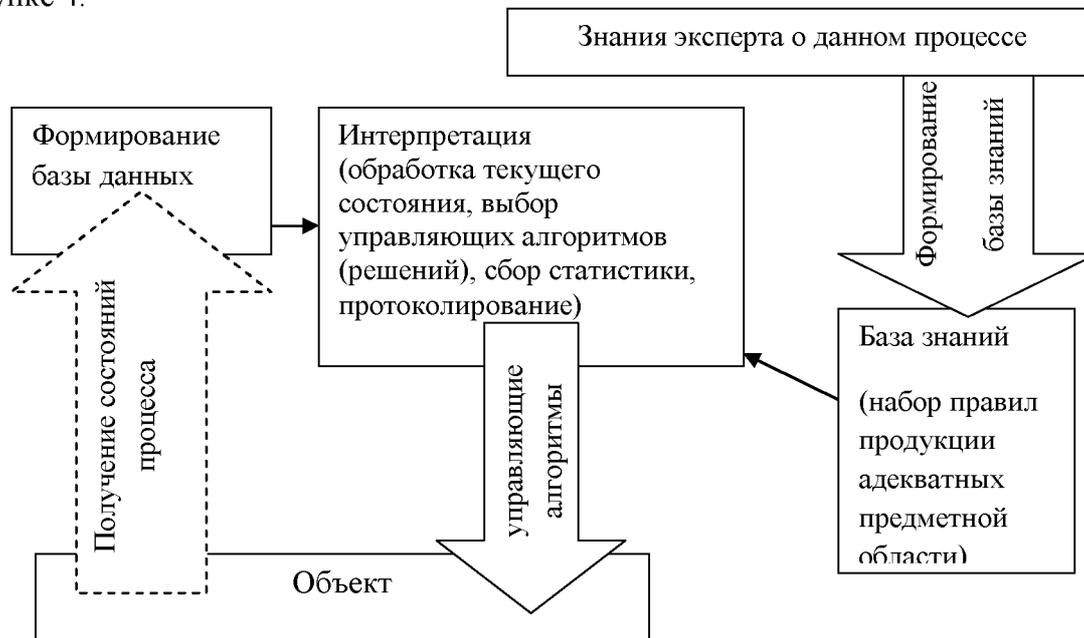
Рисунок 4 – Структура программного комплекса «Таблицы решений»
