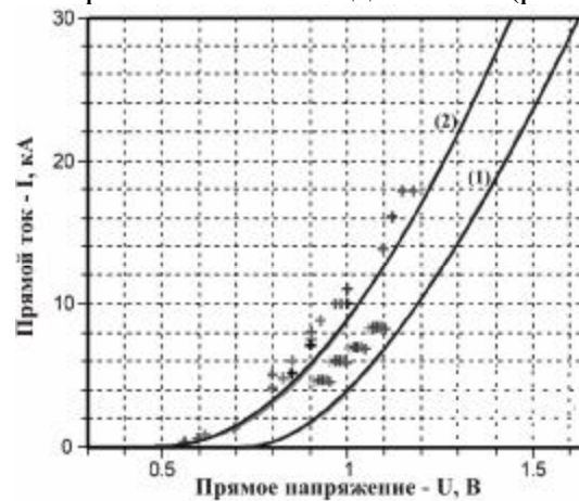
Рисунок 1 – Прямые ветви ВАХ сварочного диода Д053-7100, изготовленного по стандартной технологии
