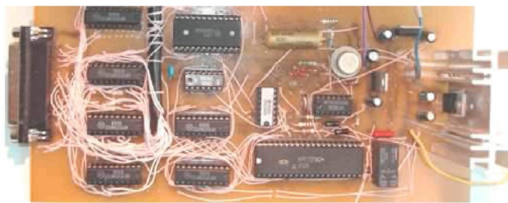
Рисунок 5 – Монтажная плата устройства коррекции
