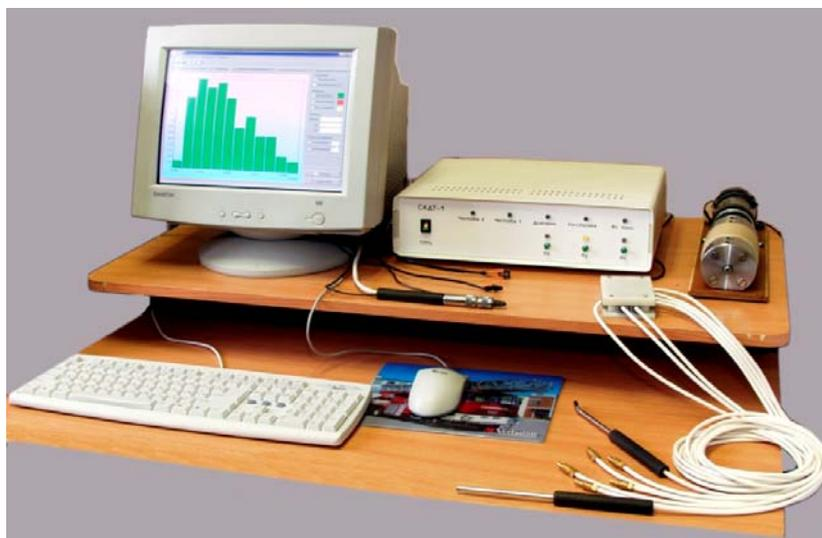
**Рисунок 2 – Внешний вид лабораторного стенда для исследования тепловых процессов в трибосопряжениях, созданного на основе системы САДТ-1**
