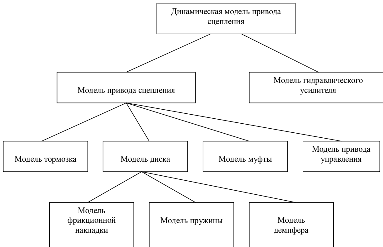
Рисунок 1 – Иерархическое представление моделей, описывающих привод сцепления
