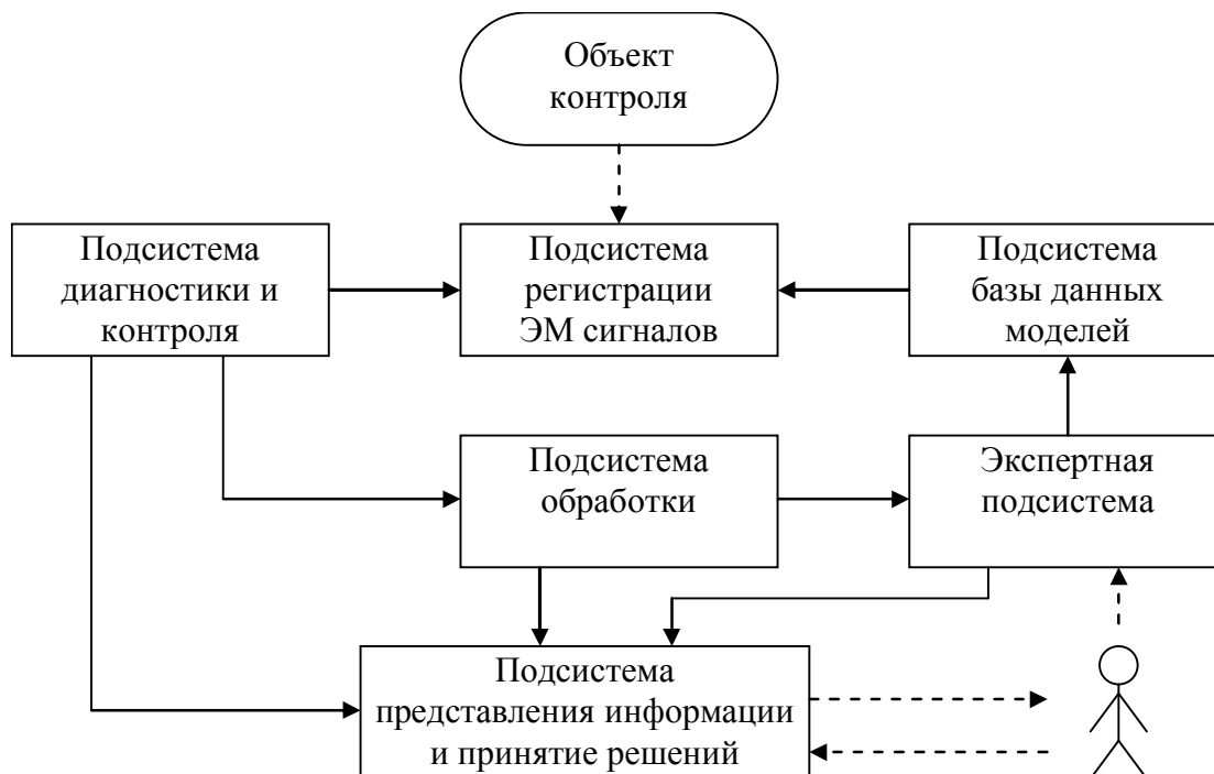
Рисунок 2 - Структура взаимосвязей подсистем автоматизированного контроля геодинамических объектов
